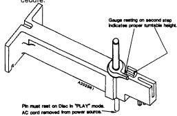
Fig. 3-8. Turntable Height Gage
