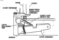
Fig. 1-9. — Unload Operation
