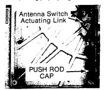
Fig. 3-4. Antenna Push Rod Cap
