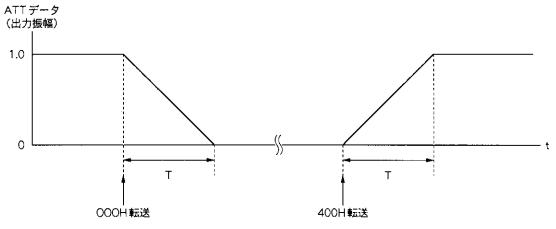
ソフトミューティングはATTとして000Hを転送することにより行います。解除するときは、ソフトミューティングをかけ る前のATTデータ(上図では400H)を転送します。
