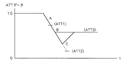
このように新しい ATT データへは、常にソフトミューティングの動作で移っていきます。上図のように ATT1 > ATT3 > ATT2 という ATT データを考え、まず ATT1 が転送され次に ATT2 が転送されたとします。ATT1 の値になる前に(図中 A の状態)ATT2 が転送された場合は ATT1 は無視されそのまま ATT2 の値に近づいていきます。
